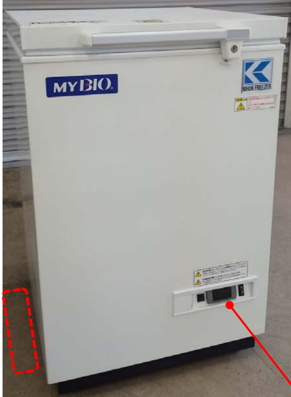
製品の周囲・機械室 (油漏れの確認)
