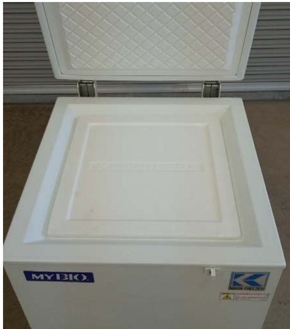
庫内・内蓋周り (外観、霜付の確認) 扉閉時にパッキンに隙間がない
