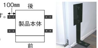
※床面への固定(アンカー打ち等)は、お客様にて対応願います。 金具の固定位置
